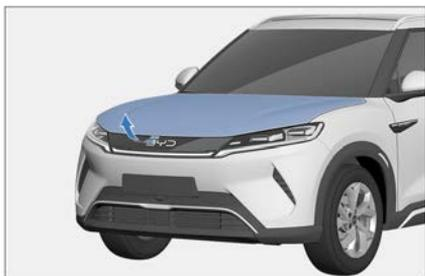
2. После закрытия капота проверьте, что его замок надежно зафиксировался. Если капот все еще можно приподнять, это означает, что он зафиксирован неправильно. Снова откройте капот и закройте его, как описано выше.
